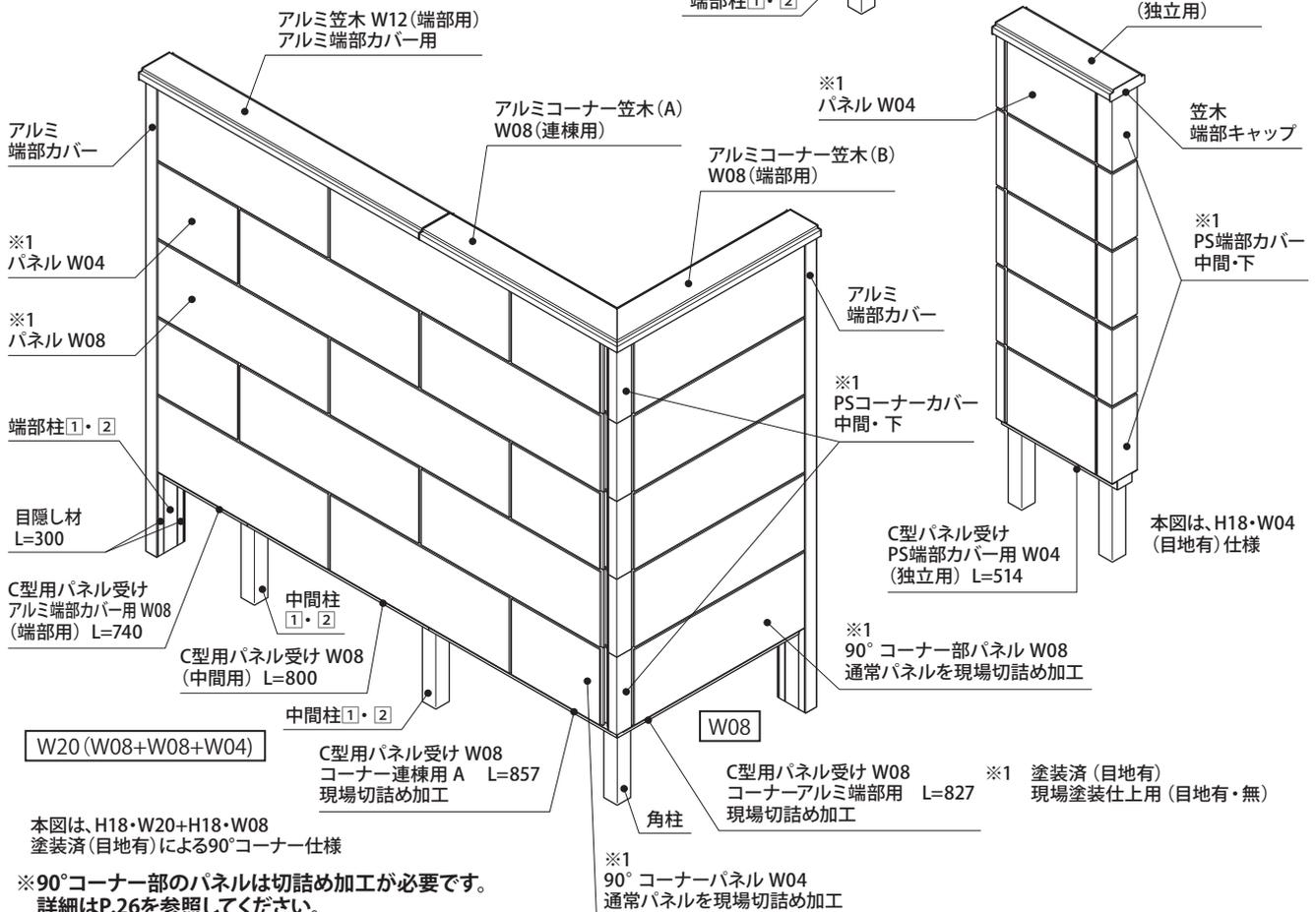
基本寸法図〈塗装済(目地有)・現場塗装仕上用(目地有・無)〉アルミ笠木・PS端部カバー仕様
