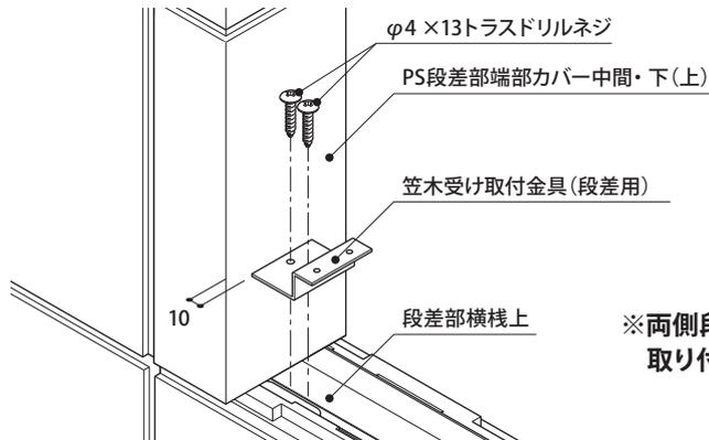
※両側段差の場合、反対側にも同じように取り付けてください。
