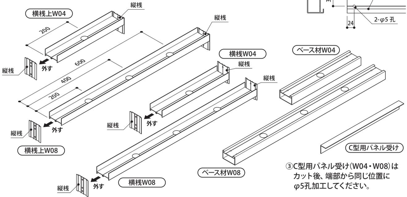
3.アルミ笠木 (W04・W08・W12・W16) ・笠木受け (W04・W08・W12・W16) の切詰め〈アルミ笠木仕様の場合〉
