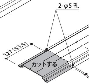
笠木受け取付金具の取付ピッチを測定し、
