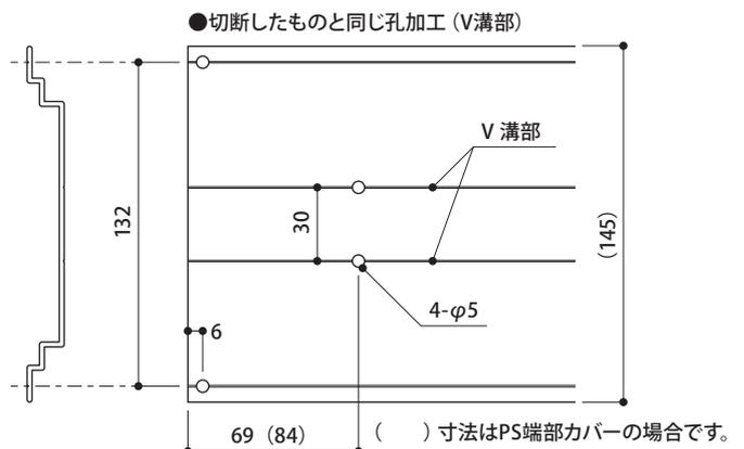
5.本現場切詰め200ピッチ〈塗装済・現場塗装仕上用・現場貼り仕上用共通〉アルミ笠木・PS笠木・アルミ端部カバー・PS端部カバー仕様
