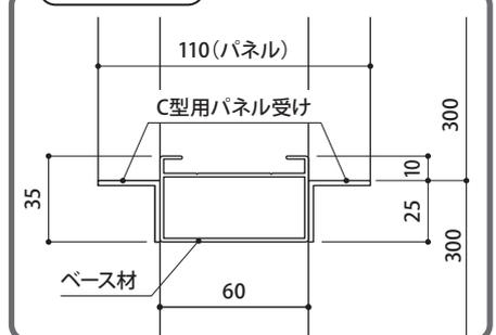
断面図〈塗装済・現場塗装仕上用・現場貼り仕上用共通〉PS笠木・PS端部カバー仕様
