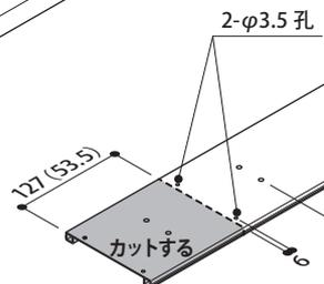
笠木受け取付金具の取付ピッチを測定し、
