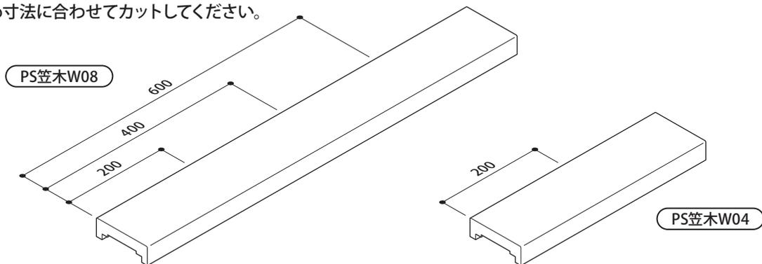
6.PS端部カバー上 (目地有・無) ・PS端部カバー中間・下 (目地有・無) の切詰め〈PS端部カバー仕様の場合〉
