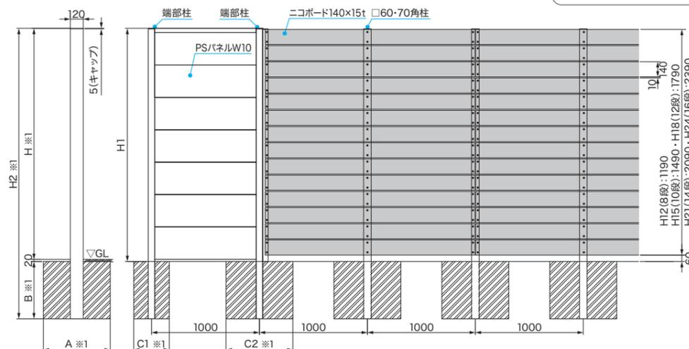
※2. 左図のようにニコボードが1スパン(1m)より大きくなる場合はアルミ柱を追加してください。ニコボード取付柱の高さは最大H2400です。柱の大きさは高さにより異なります。柱の強度は風速V0=34m/s粗度区分Ⅲを想定しています。ニコボードの耐風圧強度は自社による強度試験で安全性を確認しております。
