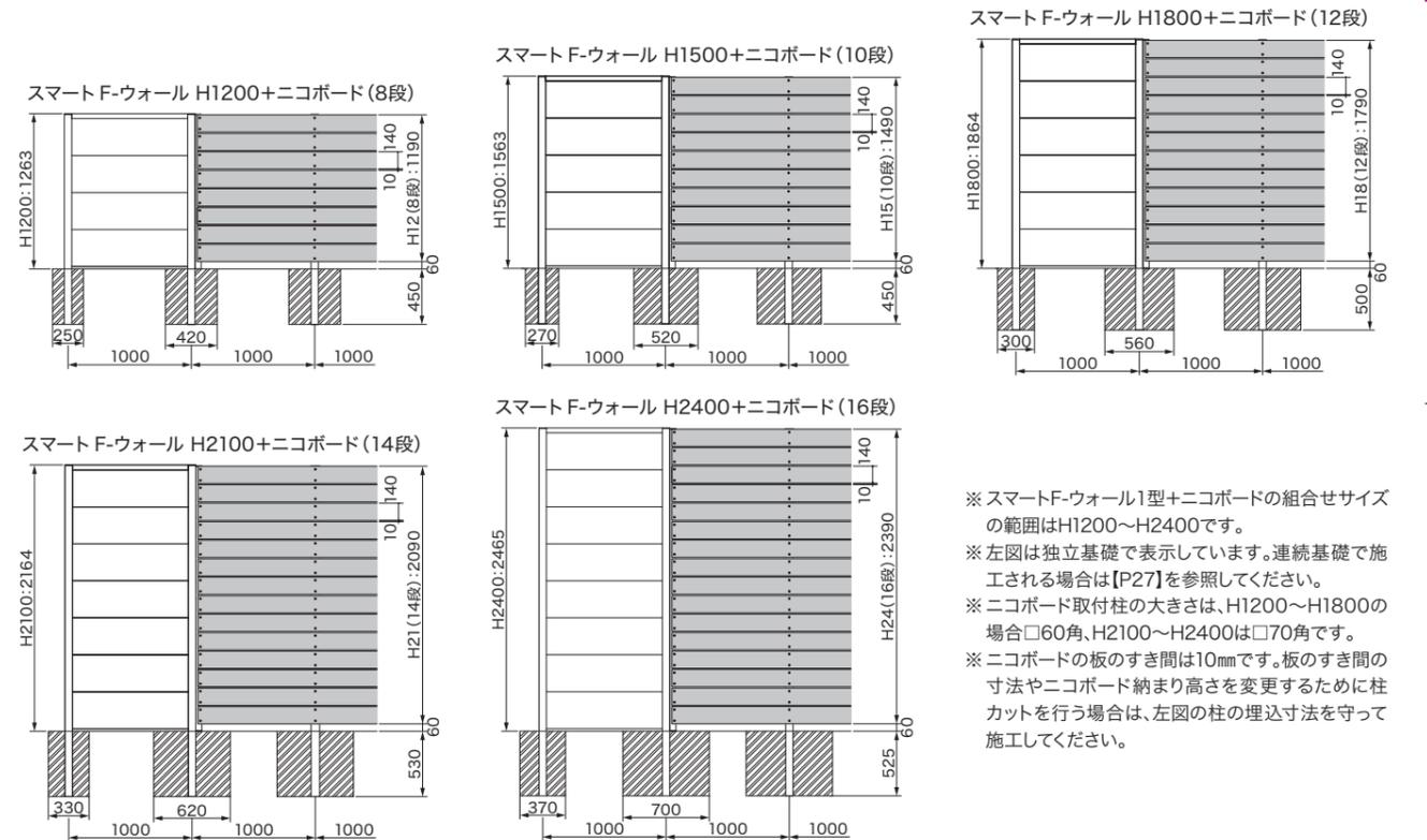
※スマートFウォール1型+ニコボードの組合せサイズの範囲はH1200~H2400です。左図は独立基礎で表示しています。連続基礎で施工される場合は【P27】を参照してください。ニコボード取付柱の大きさは、H1200~H1800の場合□60角、H2100~H2400は□70角です。ニコボードの板のすき間は10mmです。板のすき間の寸法やニコボード納まり高さを変更するために柱カットを行う場合は、左図の柱の埋込寸法を守って施工してください。
