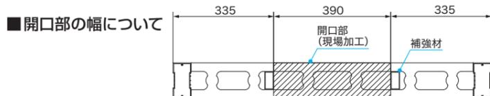
埋め込みポストの幅を測って加工幅を決めてください。
