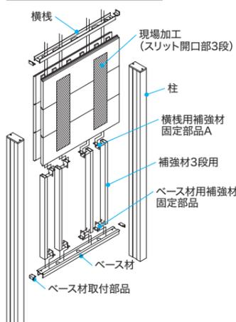
① 下図のように横棧もしくはベース材に孔加工を行い、各取付部品と補強材を取り付けてください。
