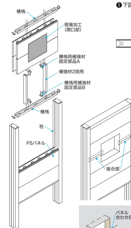
① 下図のように横棧もしくはベース材に孔加工を行い、各取付部品と補強材を取り付けてください。
