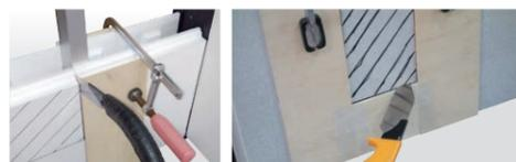
③ 横棧に孔加工を行い、補強材の固定部品Aと組付けてください。
