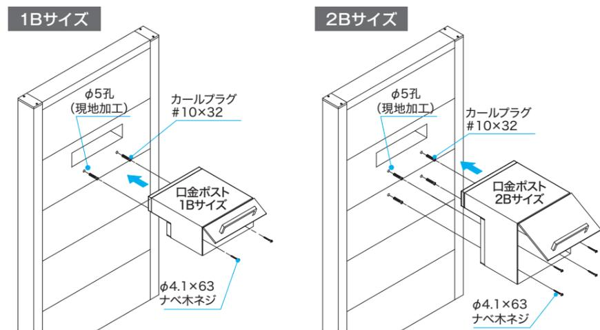
本体に口金ポスト用パネルを組み付け後、開口部に、口金ポストを差し込みポスト固定のねじ位置に合せカールプラグを下孔加工、接着剤で取り付けてください。接着剤が硬化後、φ4.1×63ナベホネジでポストを取付けてください。
