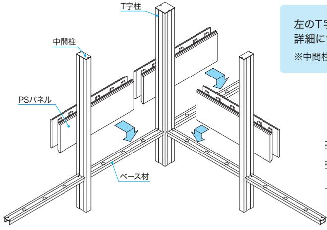
左のT字柱収まり図を参考に各部材を施工してください。詳細については取付説明書を参照願います。
